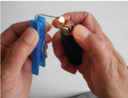
Chauffer à blanc l'extrémité du trombone / Aufgebogenes Büroklammer- ende erhitzen
