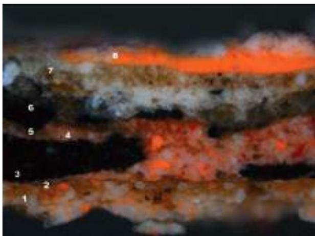
**Figura 58.** Imagen de la sección transversal de la micromuestra tomada de la túnica de Santa Ana (BF01-46). En esta micromuestra el pan de oro de la segunda policromía (5) ha sido aplicado sobre una gruesa capa de asiento a base de pigmentos de tierra, minio, albayalde y carbonato cálcico aglutinados con aceite de lino (4). Objetivo MPlan 20×/0,40.
