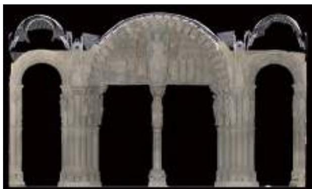
Figura 19. Inserción de la ortofoto en la nube de escáner.
