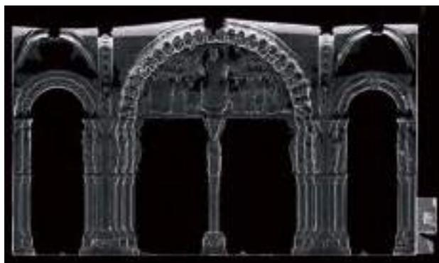
Figura 18. Alzado Pórtico seccionando la nube de escáner.
