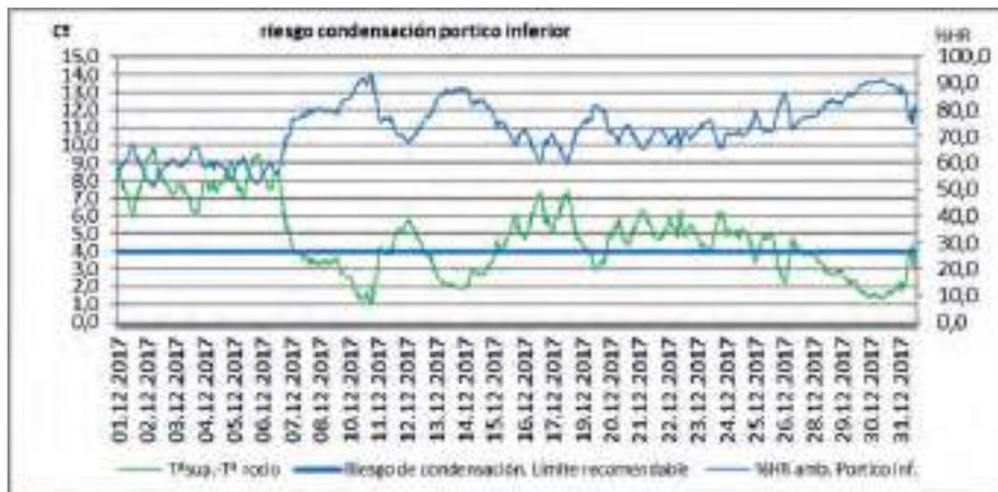
Figura 14. La línea azul continua muestra el límite del riesgo de condensación. La línea verde muestra el riesgo de condensación en la zona inferior del nártex. Esta línea es la representación de la diferencia entre la temperatura de la superficie de la piedra y la temperatura de rocío en esta superficie. Cuanto más cercana al valor 0 se encuentra la línea verde, más probable es la condensación.
