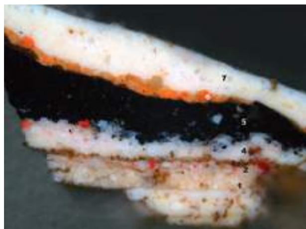
**Figura 56.** Imagen de la sección transversal de la micro-muestra tomada de la encarnación del Cristo del capitel (CA01-43). La segunda encarnación (4) en este caso aparece aplicada sobre una fina película de cola de origen animal (3). Objetivo MPlan 20×/0,40.
