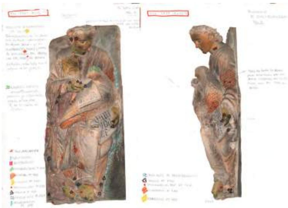
**Figura 7.** Croquis de campo sobre ortofotos del elemento PT2-TP01-RL05.
