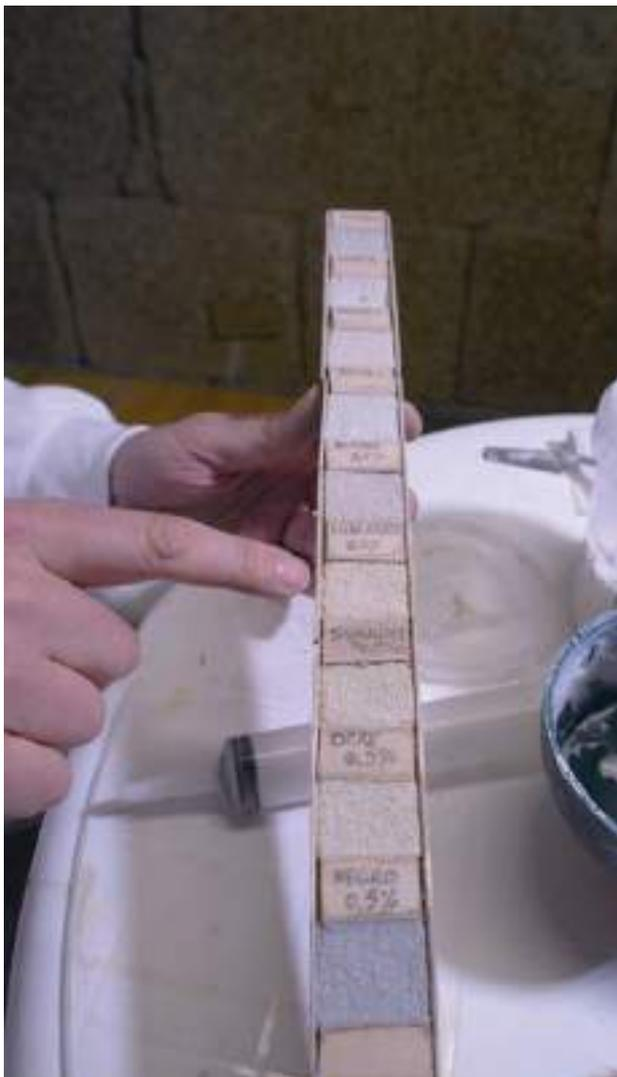
**Figura 18.** Muestras de mortero pigmentado en masa para reposición de juntas.
