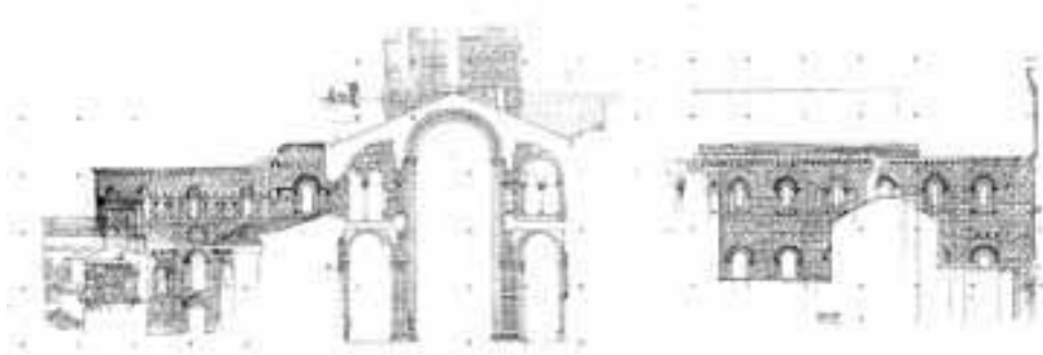
Fig. 8. Sección por el transepto norte y alzado norte de la catedral, S13. Escala original 1:50 (BTU Cottbus 2008).
