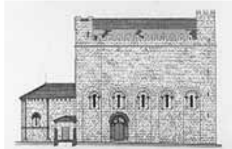
Plano 12. Alzado Norte de la iglesia de San Xoán según proyecto de traslado y restauración (Julio, 1955. APS).
