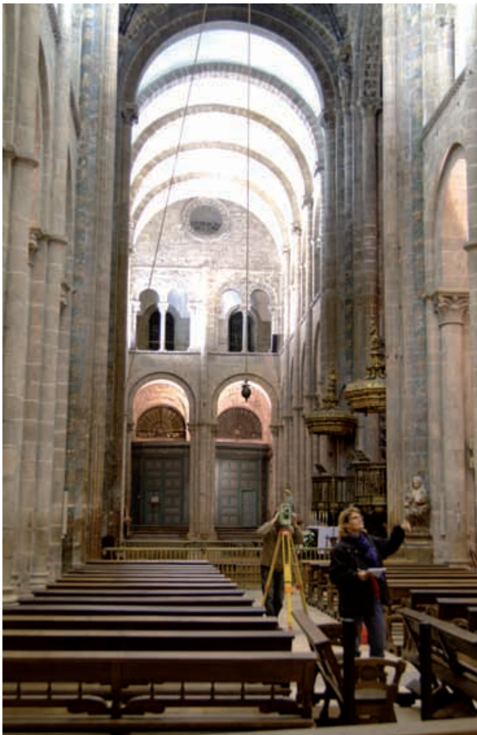
Fig. 2. Mediciones con taquímetro sin reflector en el transepto (BTU Cottbus 2008).
