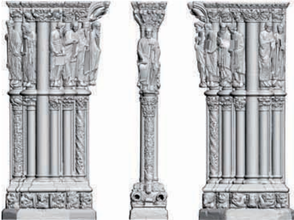
Fig. 5. Escaneado con luz rasante del Pórtico de la Gloria (Bauer/Praus 3D-Scan, BTU Cottbus 2007).
