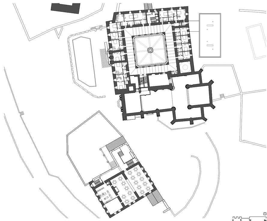
Plano 4. Planta general del conjunto monumental de San Vicente de O Pino. En negro se señalan las obras realizadas para su conversión en establecimiento hotelero. (Planimetría elaborada por la autora)
